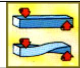
**Resistenza alla torsione:** un corpo è sollecitato a torsione quando le forze applicate tendono a torcere le sue fibre.
