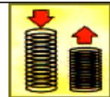
**Resistenza a fatica:** è la resistenza dei materiali a sforzi variabili e ripetuti (ad esempio, l'accorciamento e l'allungamento di una molla ripetuto per migliaia di volte)
